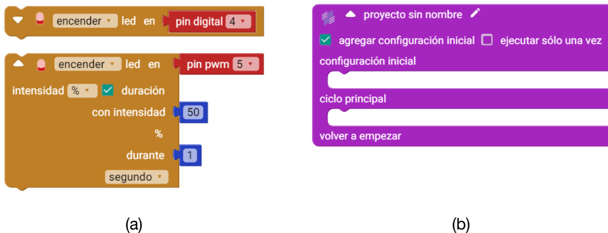
Figura 3: Algunos de los bloques de Arduino en la Escuela que admiten personalización avanzada. Mediante la flecha blanca se expande el bloque y se muestran opciones avanzadas de configuración. (a) El bloque de led colapsado (arriba) y expandido (abajo). (b) El bloque principal expandido que permite agregar código para ejecutar en la inicialización del Arduino y definir si el programa principal se va a ejecutar una vez o repetirse indefinidamente.
